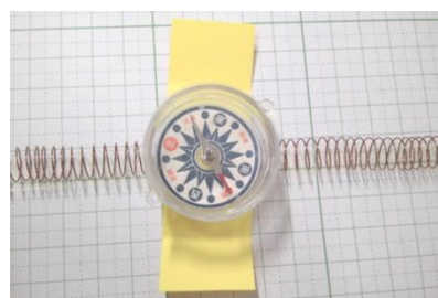
写真7 方位磁針が磁場を示したソレノイドコイル
